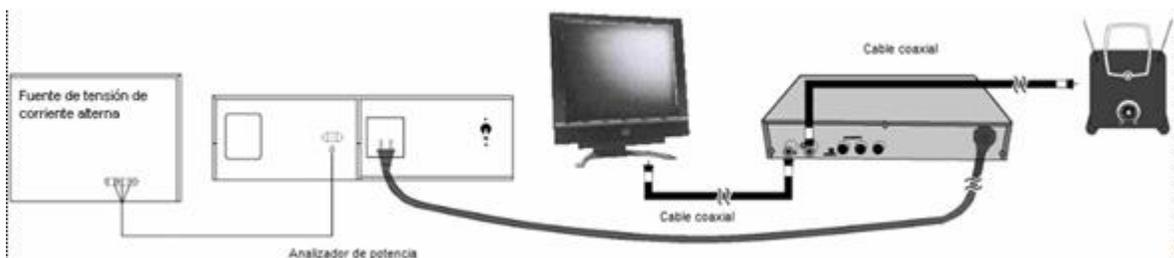
**Figura 1. Arreglo de pruebas para las mediciones de potencia eléctrica en modo de espera****7.3.1.2. Preparación de la UBP.**
